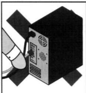
Прикасаться к задней панели системного блока и переключать разъемы интерфейсных кабелей при включенном питании.
