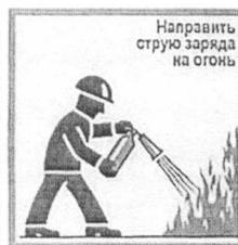
**ПРИНЦИП ДЕЙСТВИЯ** основан на вытеснении двуокиси углерода избыточным давлением. При открывании запорно-пускового устройства CO<sub>2</sub> по сифонной трубке поступает к раструбу и из сжиженного состояния переходит в твердое (снегообразное). Температура резко (до -70 °С) понижается. Углекислота, попадая на горящее вещество, изолирует его от кислорода
