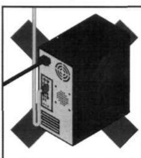
Натягивать или перегибать провода, а также располагать их вблизи от нагревательных приборов, батарей отопления.
