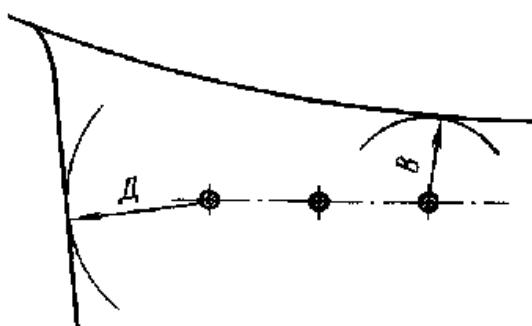
ней цепи при неотключенной верхней, а размер Д – обслуживание одной цепи при неотключенной второй.
