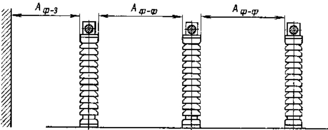
**Рис. 4.2.1. Наименьшие расстояния в свету при жестких шинах между токоведущими и заземленными частями ( $A_{\phi-z}$ ) и между токоведущими частями разных фаз ( $A_{\phi-\phi}$ )**
