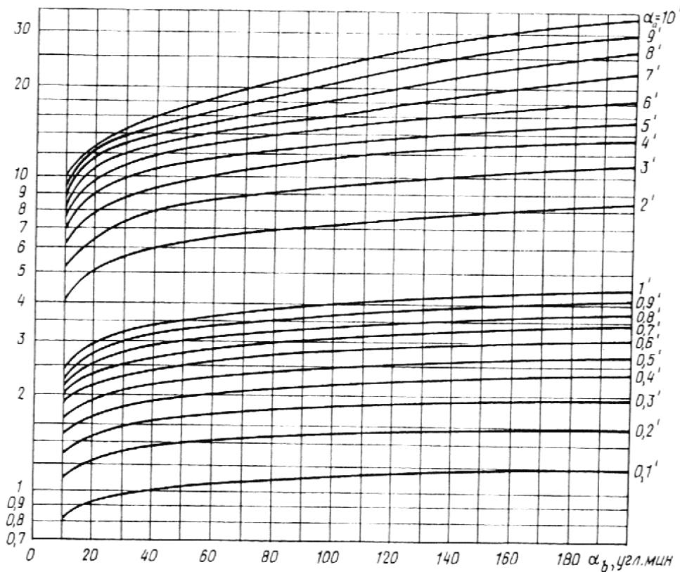
**Рисунок Б.1 — Номограмма для определения эквивалентного размера протяженных объектов различия при расстояниях от глаза до объекта более 500 мм**
