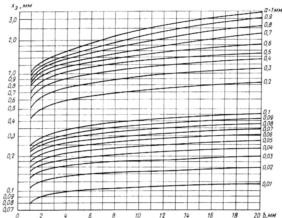
**Рисунок Б.1 — Номограмма для определения эквивалентного размера протяженных объектов различия при расстояниях от глаза до объекта до 500 мм**
