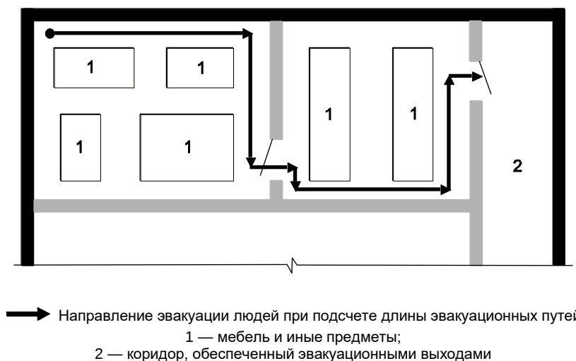
Рисунок 6.13 — Схема определения длины эвакуационного пути (от наиболее удаленной точки помещения до выхода в защищенную зону) при эвакуации людей из смежного помещения
