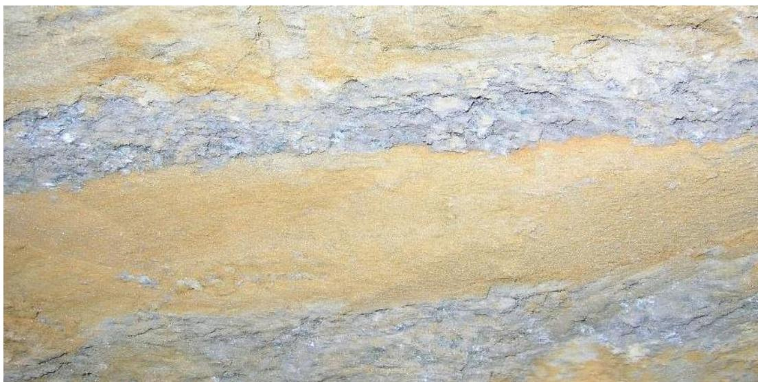
Рисунок 13 – Вертикальная структура отходов переработки медно-колчеданных руд
