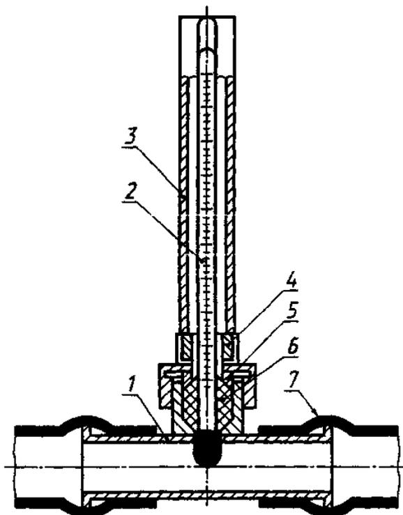
1 — тройник; 2 — термометр; 3 — кожух; 4 — гайка; 5 — кольцо; 6 — резиновое уплотнение.
