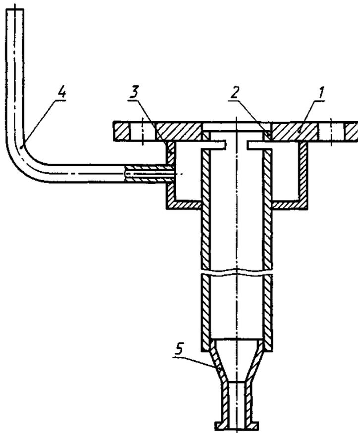
1 — фланец; 2 — труба; 3 — камера; 4 — трубка; 5 — патрубок
