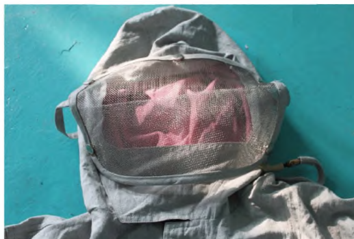
Защитная маска, электрически соединенная с проводящей одеждой
