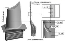
Рис. 1. Геометрические параметры лобового канала
