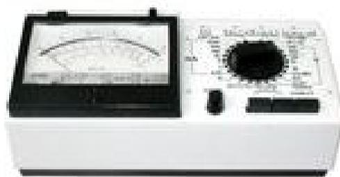
Рисунок 1.4 – Общий вид стрелочного комбинированного прибора
