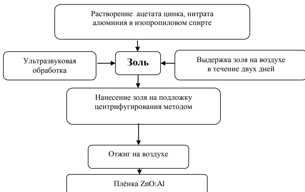
Рисунок 1 – Схема синтеза золь-гель методом слоев на основе пленок ZnO:Al
