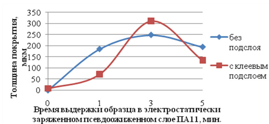
Рисунок 3 – Зависимость толщины покрытия на стальном субстрате при различном времени выдержки его в ионизированном псевдооживленном слое
