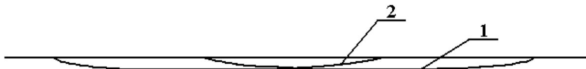
Рис. 4: Форма закалённой зоны: 1) случай однородного кольцевого пучка; 2) случай гауссового кольцевого пучка
