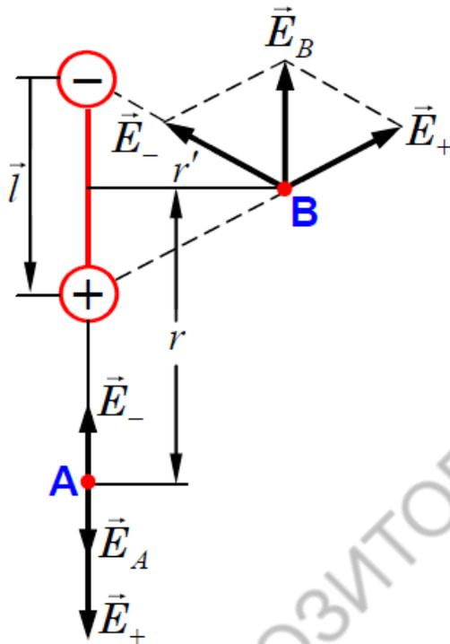
1) Напряжённость поля диполя на продолжении оси диполя в точке **A**
