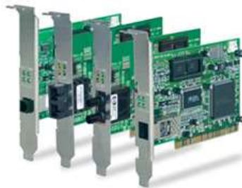
**Рисунок 3.27** – Внешний вид сетевого адаптера:
