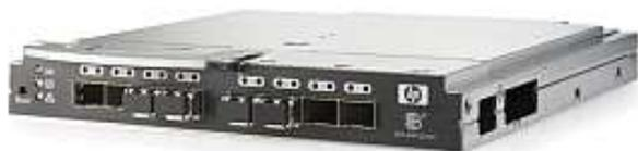
**Рисунок 3.14** – Модуль коммутатора FC для организации SAN
