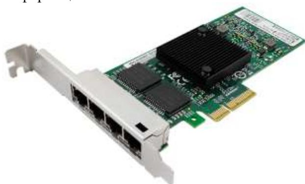
**Рисунок 4.9** – Многопортовый сетевой адаптер Ethernet
