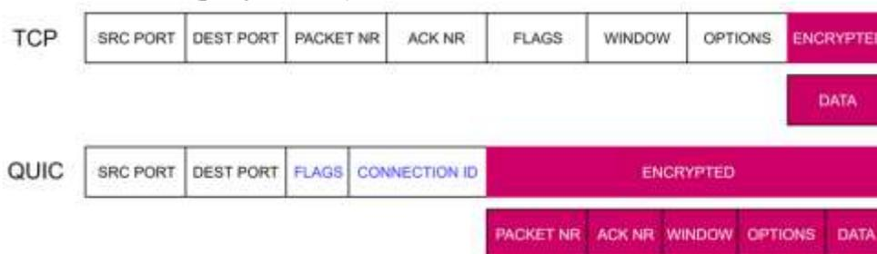
**Рисунок 6.9** – Внедрение механизмов надежной передачи в датаграмму UDP
