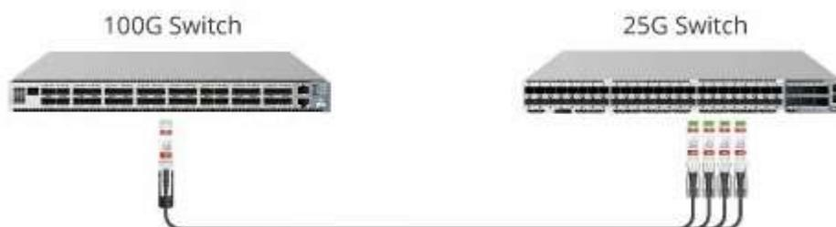
**Рисунок 3.24** – Подключение 100G QSFP28->4x SFP28 DAC
