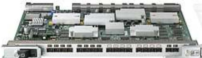
**Рисунок 3.15** – Модуль маршрутизатора
