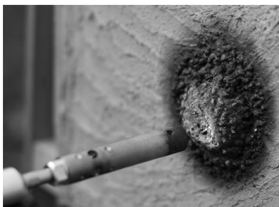
Рисунок 1 – Исследование термического воздействия открытым пламенем температурой 1700 °С образцов
