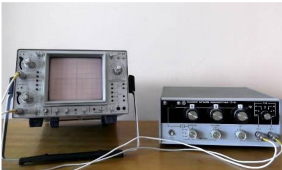
Рисунок 13 – Измерительная установка для изучения параметров переменного напряжения
