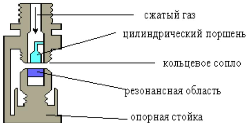
Рисунок 23.1 Ультразвуковой свисток Гальтона с резонансной полостью.
