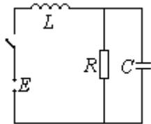
Рисунок 3. 8 – Электрическая цепь к задаче 4 домашней работы
