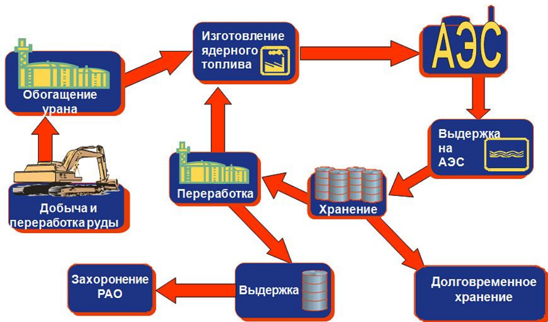
Рисунок 14 – Схема обращения с ядерным топливом в России
