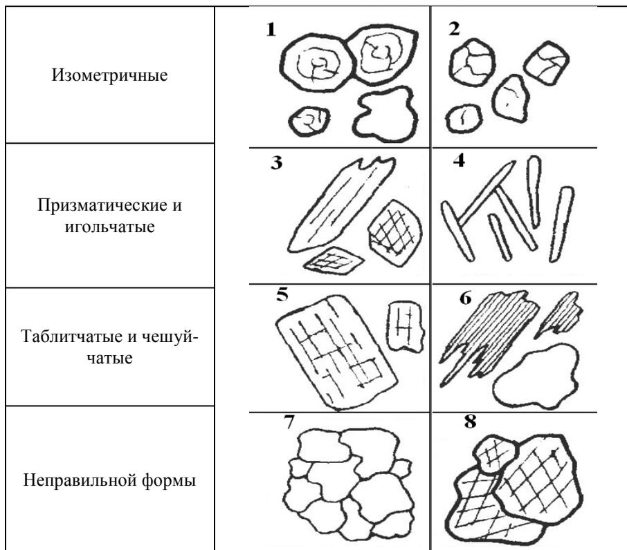
Рис. 6. Типичные формы минералов в шлифах:
