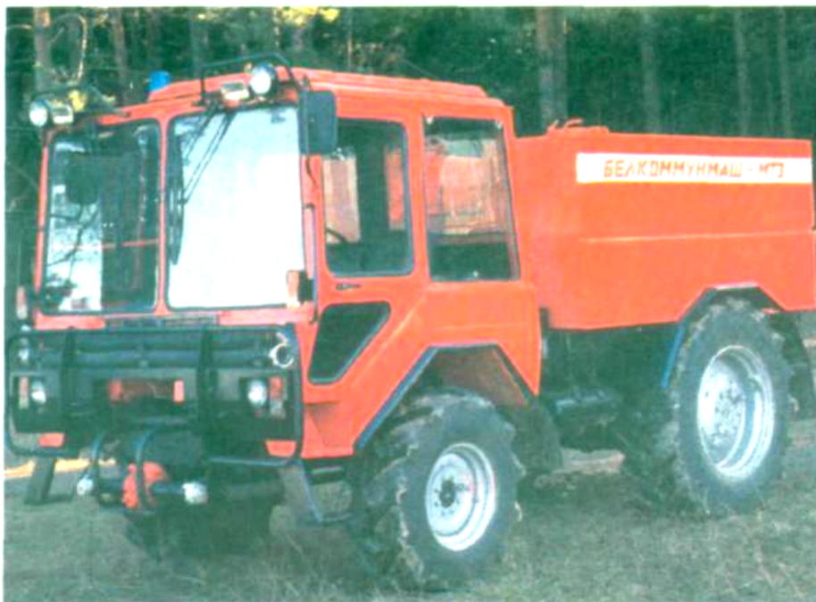
Рисунок 5.22 – Машина лесопожарной охраны МЛ-10 (356)
