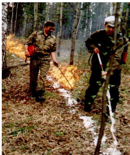
Рисунок 5.16 – Зажигание на- почвенного покрова при пуске отжига от опорной полосы, по- средством зажигающего ап- парата АЗ-1.
