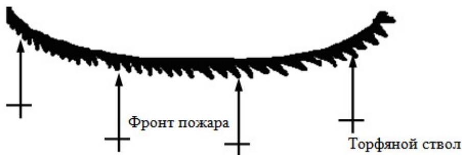
Рисунок 5.2 – Схема локализации очага горения торфяного пожара в начальной стадии возникновения с применением торфяных стволов
