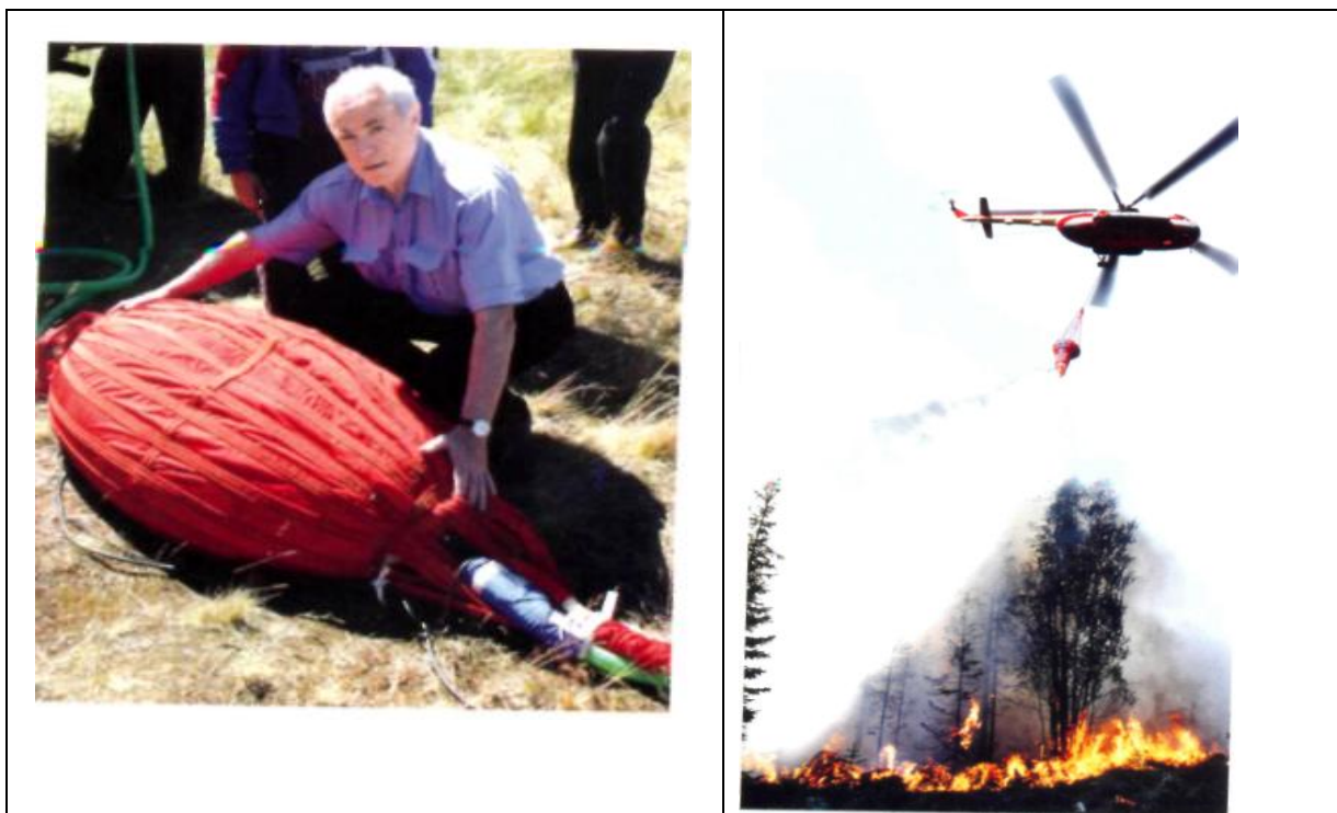
Рисунок 5.14 – Подготовка к работе водосливного устройства (ВСУ) и использование его при тушении лесного пожара
