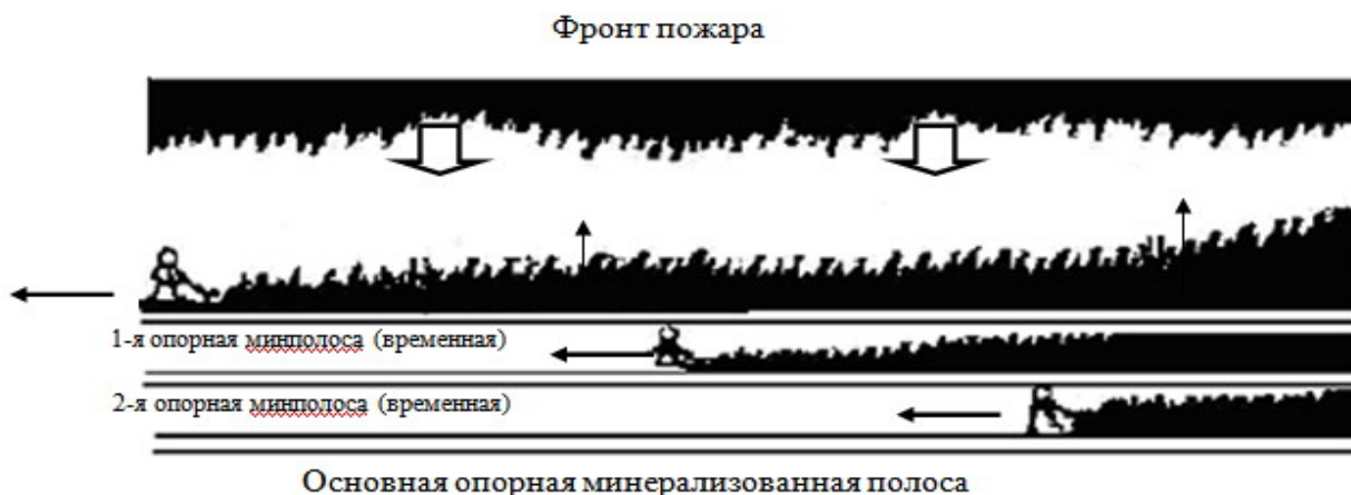
Рисунок 5.20 – Отжиг «ступенчатым огнем»
