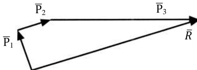
Рисунок 3.10 – Сложение сил методом многоугольника
